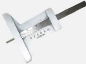
**MEDIDOR DE DESGASTE
