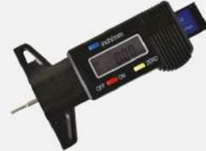
**MEDIDOR DE DESGASTE
